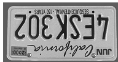
převrácený obraz při pozorování okulárem vloženým přímo do teleskopu
