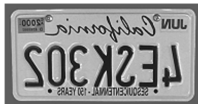
převrácený obraz při pozorování s vloženým Zenitovým hranolem
